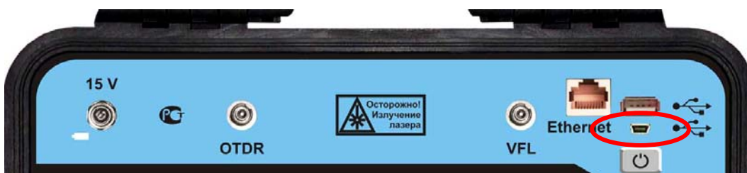
Рис. 84. Разъем mini USB для подключение прибора к ПК.
