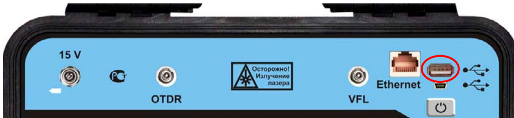
Рис. 47. Подключение Flash накопителя.
