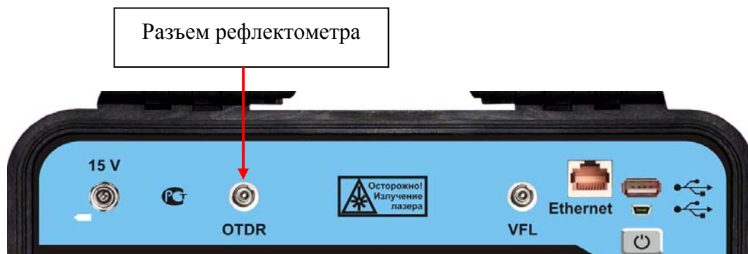
Рис. 12. Подключение оптического волокна.
