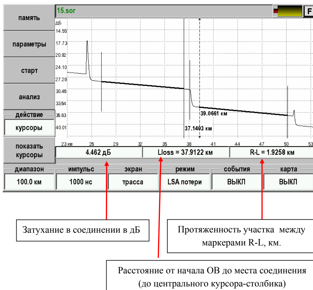
Рис. 35. Измерение затухания в соединении ОВ.
