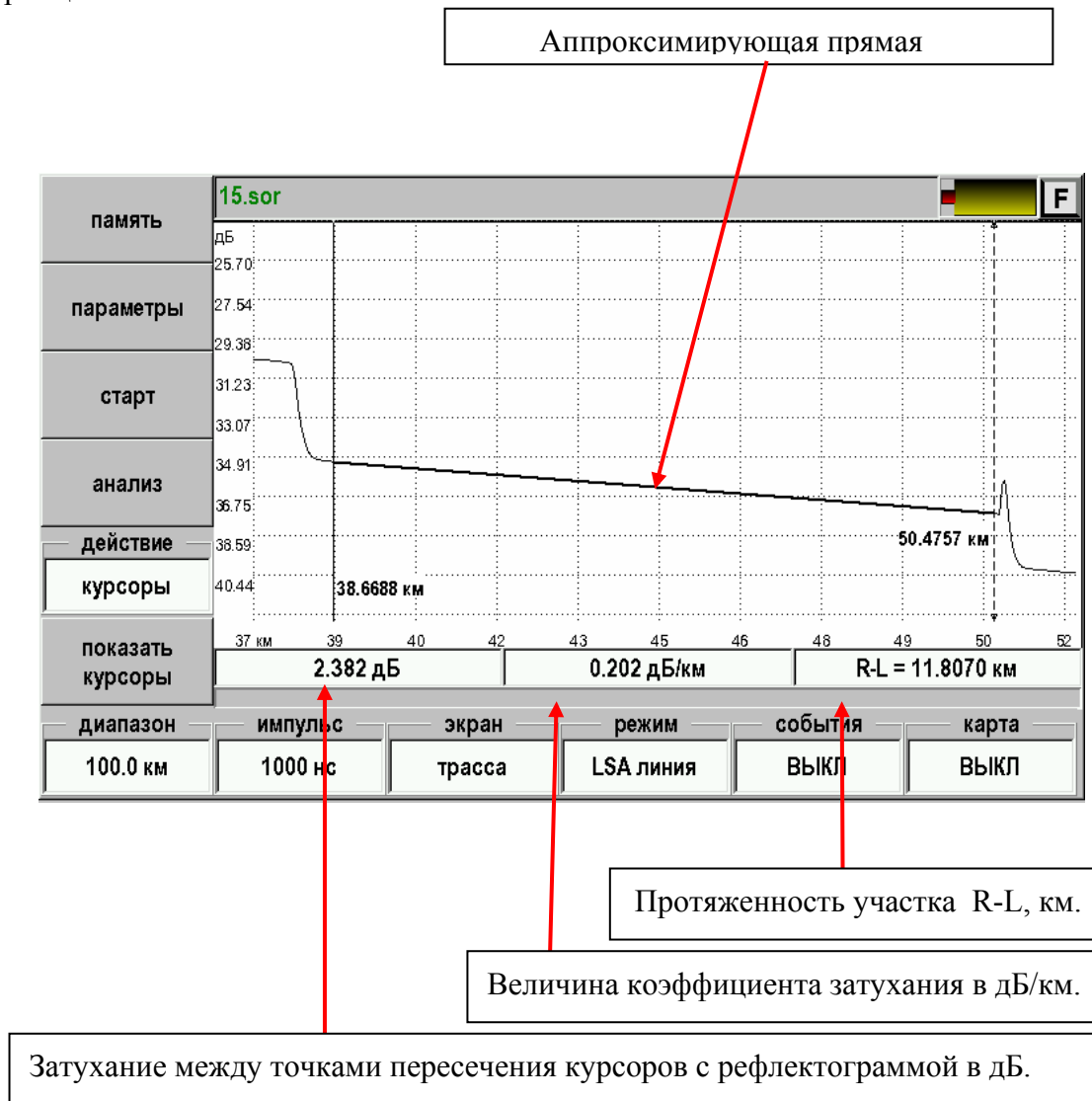
Рис. 34. Измерение погонного затухания участка волокна аппроксимацией прямой линией.
